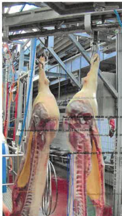
Abbildung 18 Detektion und Klassifizierung zwei Schweinehälfte. Die linke und rechte Hälfte wird bei jeder Detektion unterschieden: das Brustfell (Grün) und das Bauchfell (Orange) werden detektiert; die Schwänze werden detektiert und die Schwanzlänge wird geschätzt; die Haut (grüner Umriss) und die nicht mit Haut bedeckte Seite werden detektiert (blauer Umriss).
